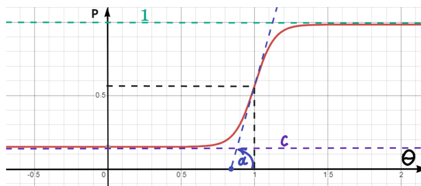
Рис. 3.4.1 — Характеристична крива складності r_0 з дискримінаційною спроможністю d=4 \cdot \tan \alpha та шансом вгадування c
